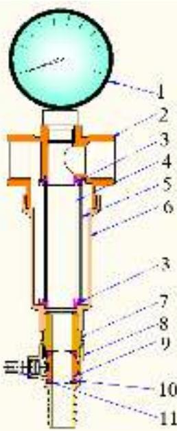
Фильтр состоит из корпуса 2 и колбы 6, выполненных из горячештампованной латуни CW617N с гальванопокрытием из никеля. Между собой корпус и колба соединены на резьбе с кольцевой прокладкой из EPDM.
